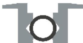
Rainure de clavette horizontale à 120° pour tuyaux de serrage et autres pièces rondes
