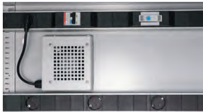
Temperaturgesteuerter Lüfter und Zentrale Masterleiste beim Comfort-Schrank
